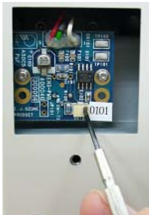
ボリューム調整 (図-7のAから見る)
